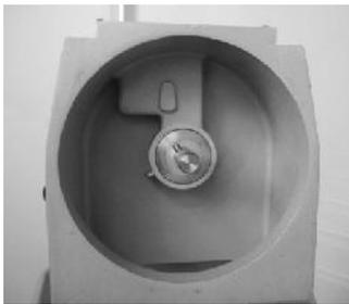
Das Würfelgatter hat eine Ober- und Unterseite und passt nur in einer Lage in das Gehäuse hinein.
