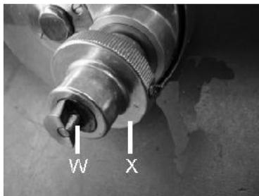
In der Hülse (X) befindet sich eine federbelastete Kugel. Diese Kugel sichert den richtigen Sitz des Werkzeuges. Unter Umständen kann das Verschieben der Hülse (X) etwas schwergängig sein. In diesem Fall bewegen Sie die Hülse mit einem kräftigen Ruck auf- oder abwärts.
