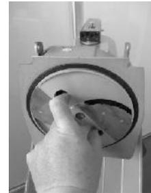
Drücken Sie das Würfelgatter von hinten aus dem Gehäuse heraus.
