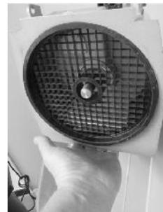
Zur Grobreinigung des Würfelgatters sollten Sie den mitgelieferten Reinigungskamm verwenden.
