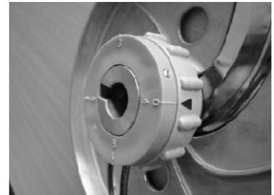
Die Reib- und Streifenscheiben werden mit dem Ausziehgriff ( bei G 25 K enthalten ) ebenfalls durch Linksdrehung von der Antriebsnabe abgezogen.
