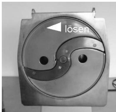
Die Schnittstärkenverstellung darf nur bei demontierter Scheibe vorgenommen werden!
